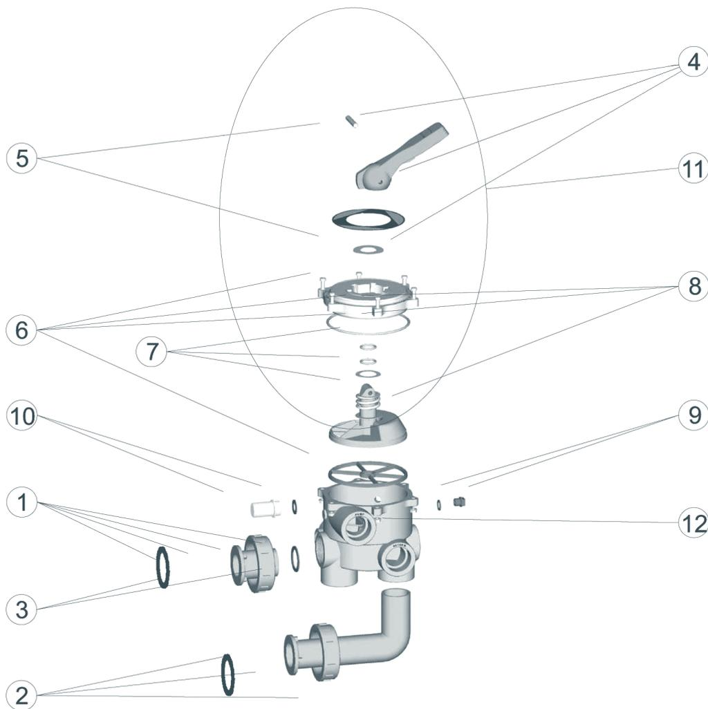
**VÁLVULA SELECTORA TORNILLO 1 1/2" CON ENLACE A FILTRO**
