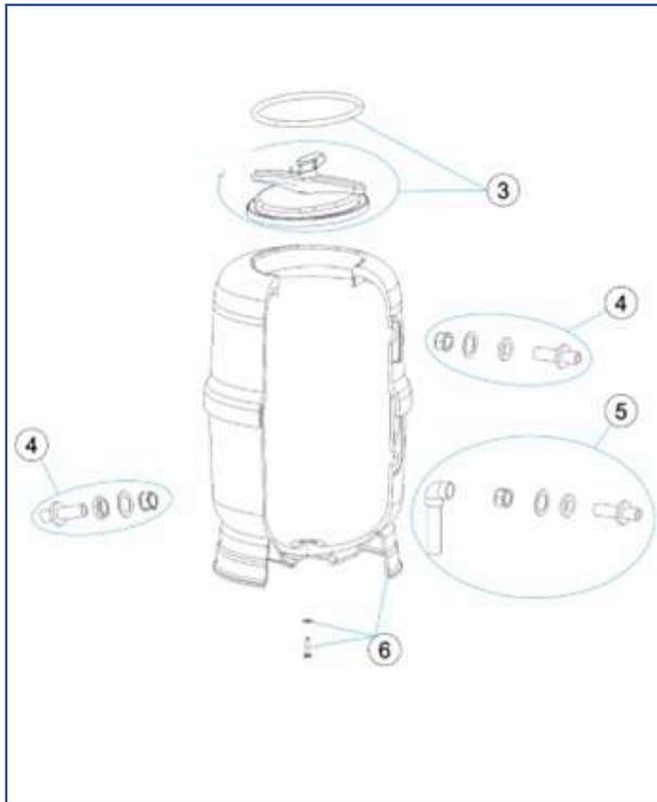
Conjunto para conexión de abonador de 40 a 400 l. Compuesto de: tuerca, junta y pasamuros en PVC de 3/4" roscado
