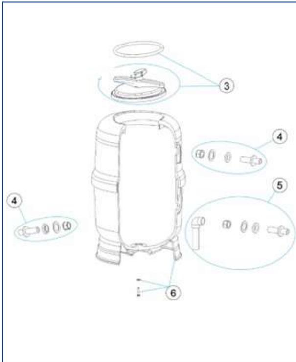
Conjunto pie Clorimax o abonador 40-400 l. compuesto de: base, tornillo y arandela
