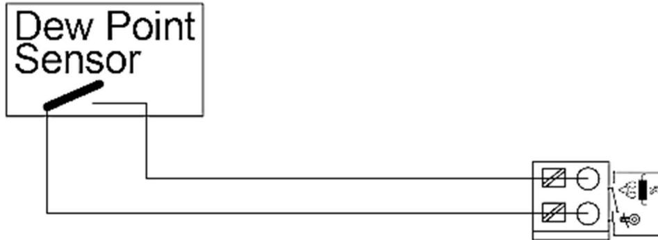
Se tiene que quitar el puente para conectar el sensor de humedad.
