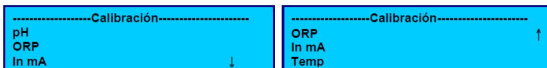
Mediante las teclas Arriba y Abajo, seleccionar la sonda a calibrar y presionar ENTER.
