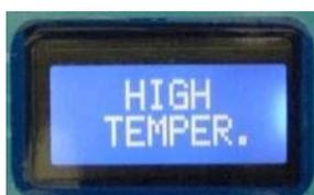
En caso de alta temperatura del colector. Puede pasar si no hay flujo o si hay aire en el colector. En este caso la instalación se apaga.
