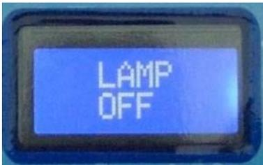
En caso de lámpara no funcionante. Si la instalación lleva 2 lámparas se identifica la lámpara estropeada. Verifique que la lámpara sea integra y/o que el encendedor funcione
