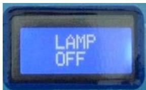
En caso de lámpara no funcionando. Si la instalación lleva 2 lámparas se identifica la lámpara estropeada. Verifique que la lámpara sea íntegra y/o que el encendedor funcione.
