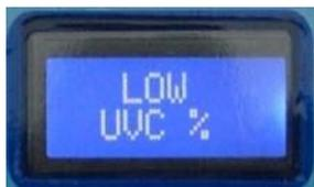
En caso de radiación baja por causa de cuarzo sucio o lámpara agotada o agua con transmisión baja de UV o cuarzo del sensor sucio.
