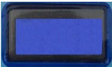
Pantalla apagada, en caso de que el cuadro no sea alimentado o el fusible de la tarjeta de potencia se haya quemado.
