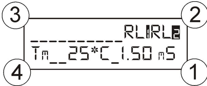
Bereich 1 = Anzeige chemische Leitfähigkeitsmessung
