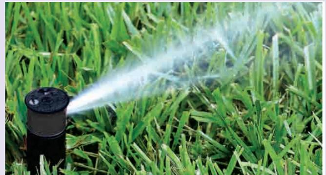
MiniPro es un aspersor de turbina, capaz de regar una zona entre 5,1 a 9,1 metros de radio, y a una presión en la boquilla de 2,1 a 3,4 bares con un caudal de 2,84 a 12,5 L/M. El MiniPro se suministra con cinco (5) boquillas intercambiables y codificadas numéricamente. La trayectoria de la boquilla es de 26º. El aspersor dispone de un tornillo de ajuste del chorro en acero inoxidable.
