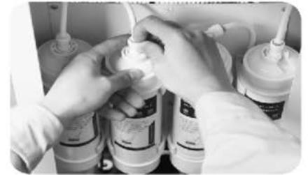
**DESMONTAR PANEL PARA EL ACCESO A LOS FILTROS, SAQUE LA ANILLA AZUL Y DESCONECTE LOS FILTROS PARA SU SUSTITUCIÓN**
