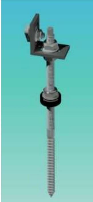
Primer paso: atornillamiento de soportes a la cubierta hasta ajustar la arandela de goma para conseguir la estanqueidad.
