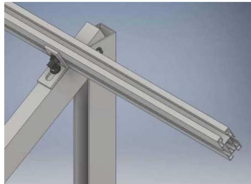
Unir los perfiles portaplacas a las escuadras que están en los triángulos con el tornillo cabeza martillo dispuesto a tal efecto. Comprobar que los triángulos están paralelos entre sí.
