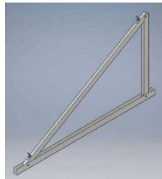
Unir los dos perfiles con el tornillo y el tubo que están en el perfil U inferior. Apretar los 3 tornillos del triángulo.
