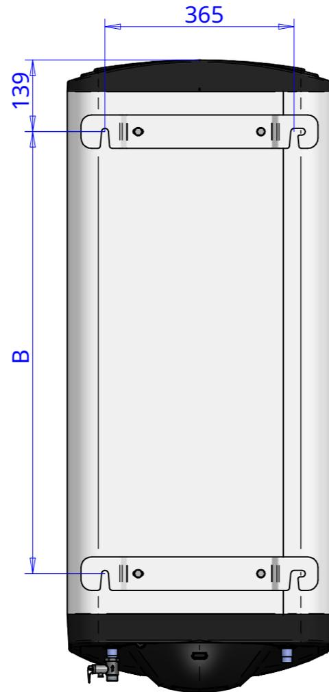
**CALENTADORES DE AGUA ELÉCTRICOS DOBLES DE ACUMULACIÓN PARA MONTAJE UNIVERSAL EN PARED**
