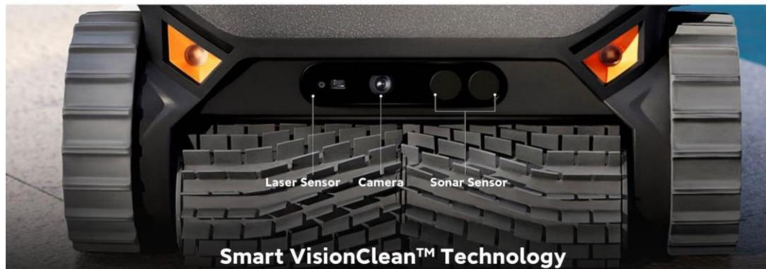
**Sistema de cámara con IA:** La tecnología de fusión multisensor con cámara permite la detección precisa del terreno y los residuos.
