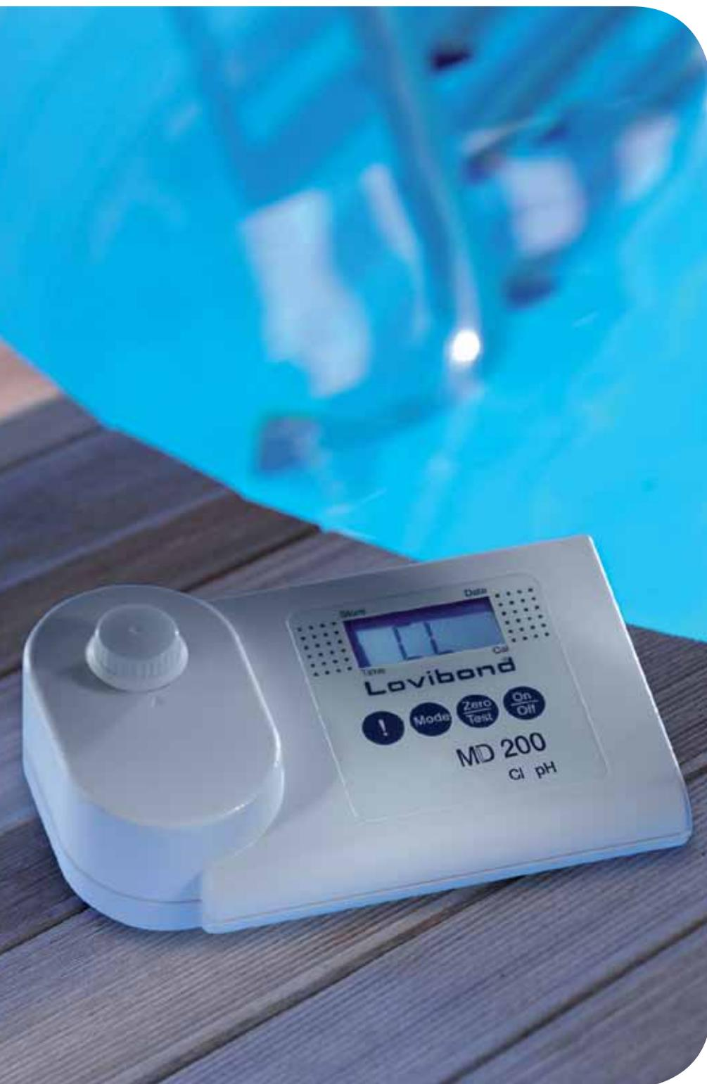
Resultados precisos de medición con filtros de interferencia de alta calidad
