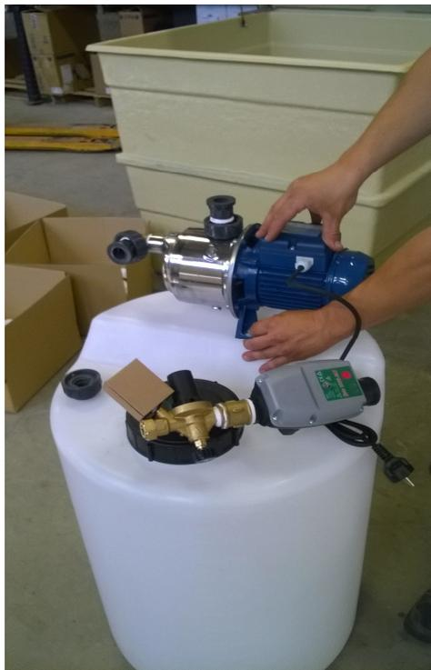
2. Acoplamiento del control presión a la bomba.
