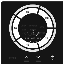
ALARMA CÉLULA Led CELL parpadea
