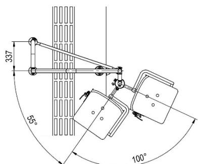
Elevador hidráulico, para facilitar a aquellas personas discapacitadas o con movilidad reducida que necesitan efectuar su entrada y salida del vaso de la piscina. Se compone de una estructura en tubo Ø 43 mm de acero inoxidable AISI-316 acabado pulido brillante en la que se adapta el mecanismo hidráulico donde se soporta el asiento.
