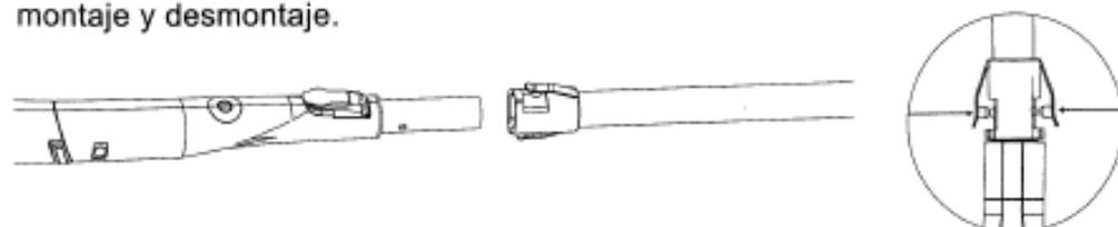
Gire el anillo en sentido contrario a las agujas del reloj hasta que sienta que se detiene, ajuste la longitud del poste de aluminio que desee, luego gire el anillo en sentido de las agujas del reloj para bloquearlo.
