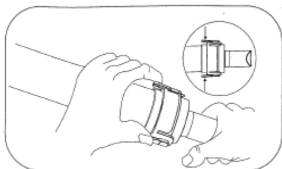
1. Presione los dos paneles como se muestra en las imágenes en la cabeza de la aspiradora, tire suavemente de la cabeza de succión hacia fuera.
