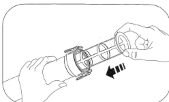
4. Vuelva a colocar el cartucho filtrante en el tubo transparente con la abertura hacia el exterior.
