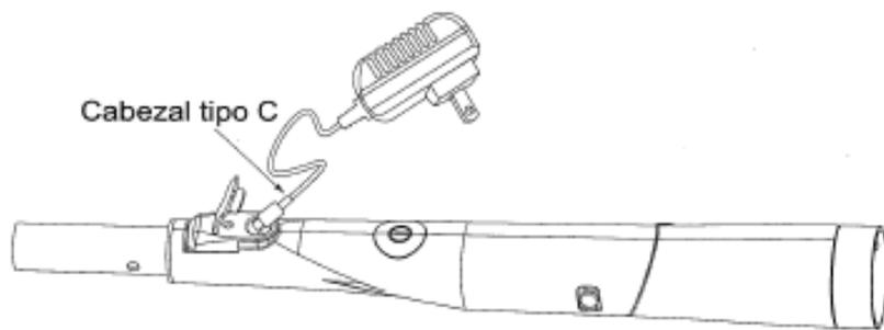
Nota: Después de cargar la aspiradora cada vez, recuerde sellar la tapa de carga para proteger el puerto de carga del agua. Si no se usa durante más de tres meses después de haberla cargado completamente, recargue la aspiradora una vez más antes de usarla.
