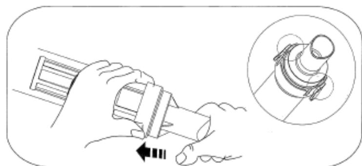
5. Presione los dos paneles y deslice el cabezal de succión hacia atrás. Asegúrese de que los dos cierres que sobresalen mantienen el cabezal de succión en su lugar.
