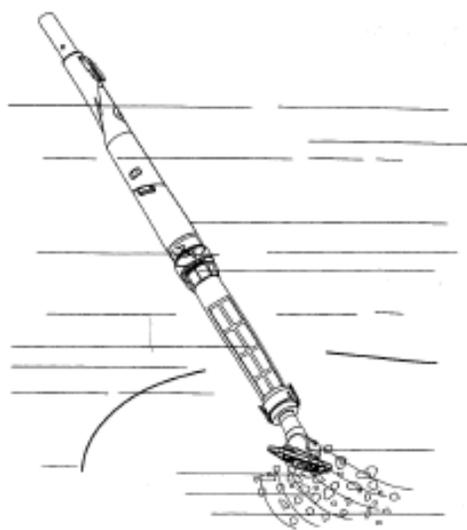
B. Para limpiar y eliminar la suciedad (mayor de 120µm y menor de 1 cm) del fondo del Spa/Piscina con cabezal triangular.
