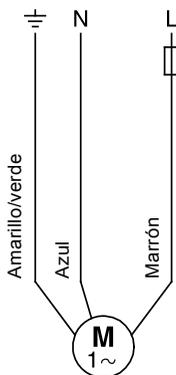
Fig. 9 Motores de 2 cables
