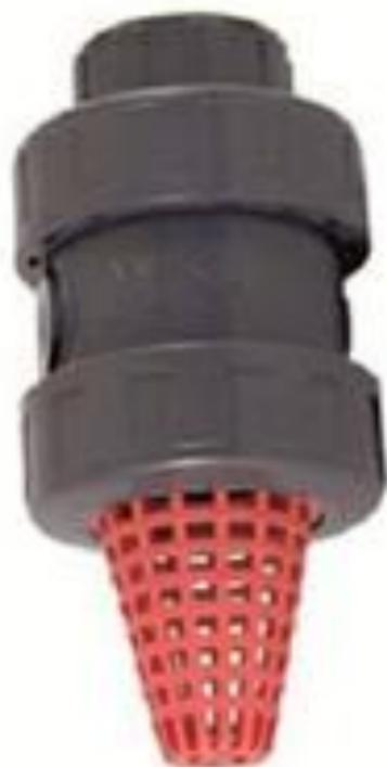
Válvula de pie, cuerpo y cono de cierre en PVC-U, muelle inox.AISI 302. Apta para instalaciones de riego, piscina e industria. Su construcción en PVC permite su uso en aguas agresivas. Instalación horizontal o vertical.
