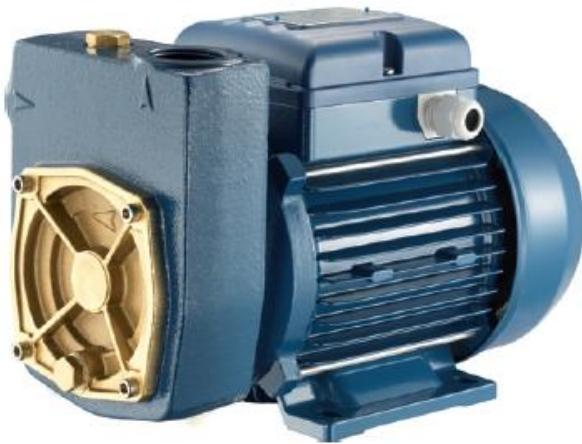
Pompa volumetrica ad anello liquido con girante stellare che conferisce alla pompa una notevole capacità aspirante. Particolamente adatte nelle operazioni di travaso di liquidi (anche volatili). Corpo pompa con chiusura in ottone a riduzione del rischio di bloccaggio.
